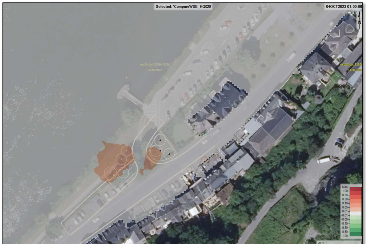
Abbildung 45: Wasserspiegel-Differenzen (PLAN minus IST), [m], Lastfall: HQ 20
