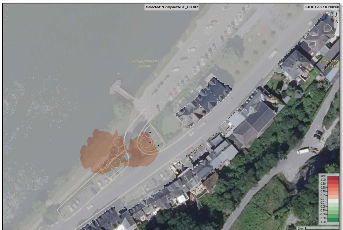
Abbildung 47: Wasserspiegel-Differenzen (PLAN minus IST), [m], Lastfall: HQ 100
