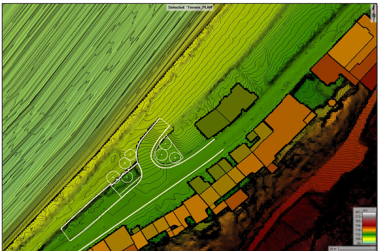
Abbildung 4: Digitales Geländemodell im PLAN-Zustand
