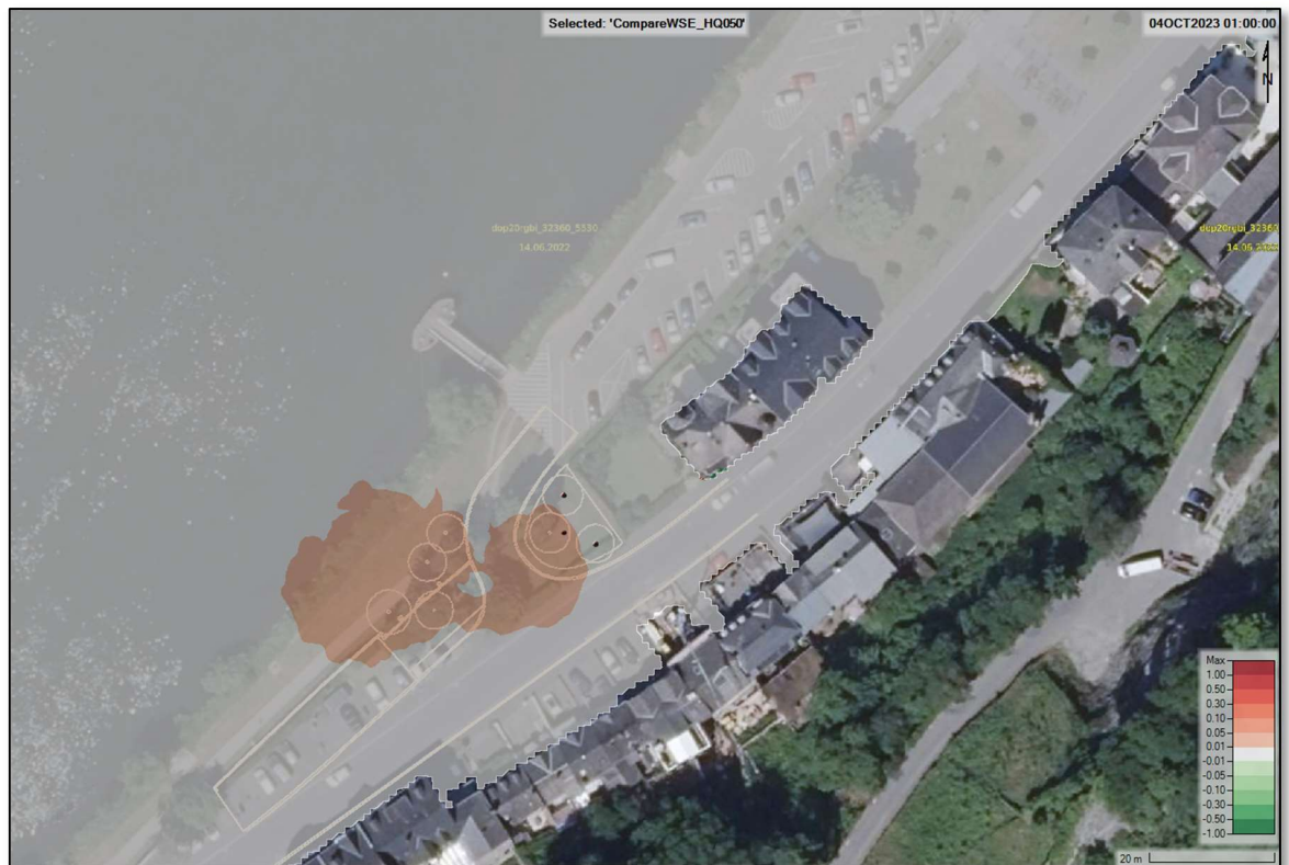
Abbildung 46: Wasserspiegel-Differenzen (PLAN minus IST), [m], Lastfall: HQ 50
