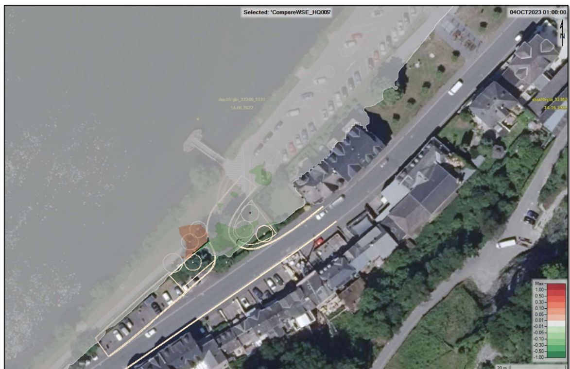
Abbildung 43: Wasserspiegel-Differenzen (PLAN minus IST), [m], Lastfall: HQ 5
