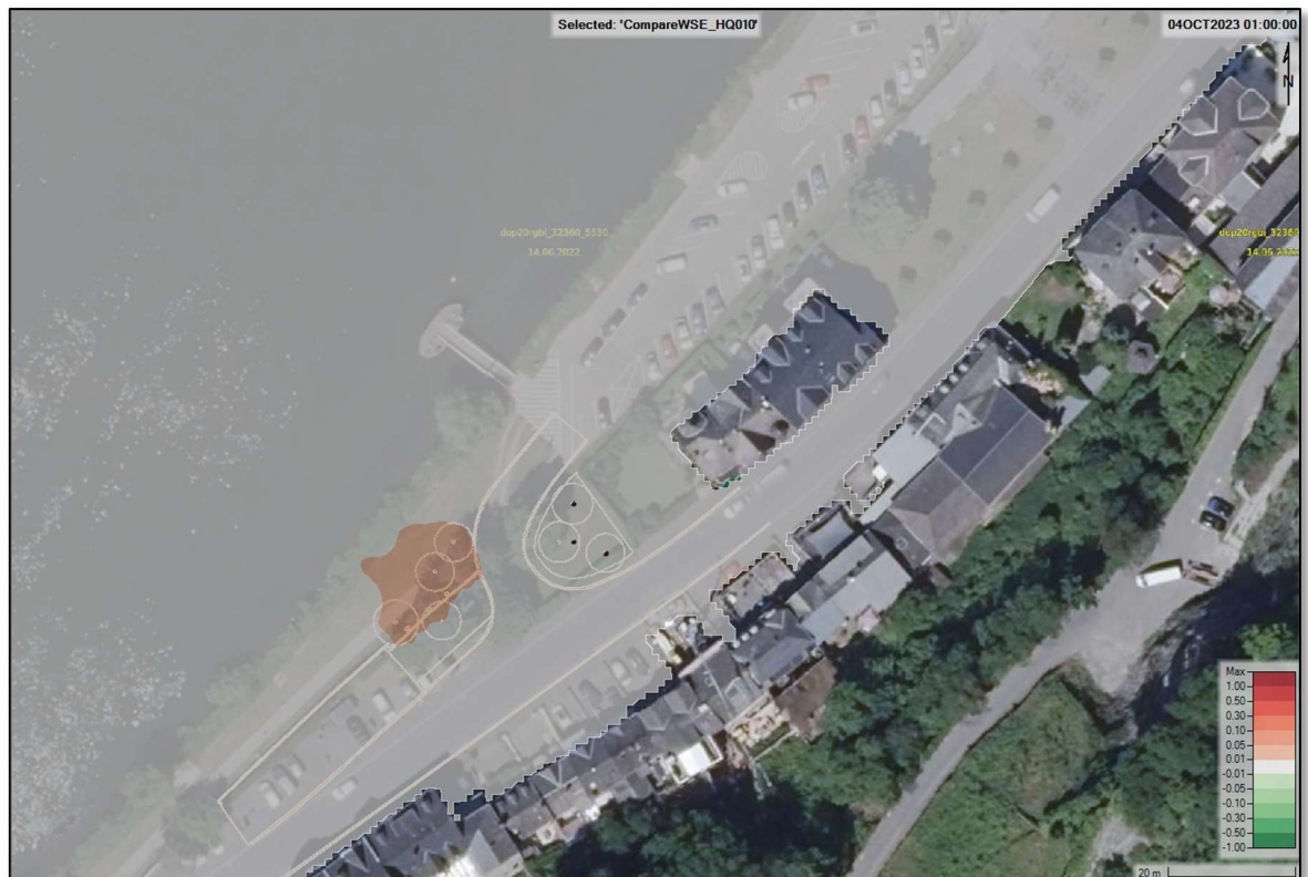
Abbildung 44: Wasserspiegel-Differenzen (PLAN minus IST), [m], Lastfall: HQ 10
