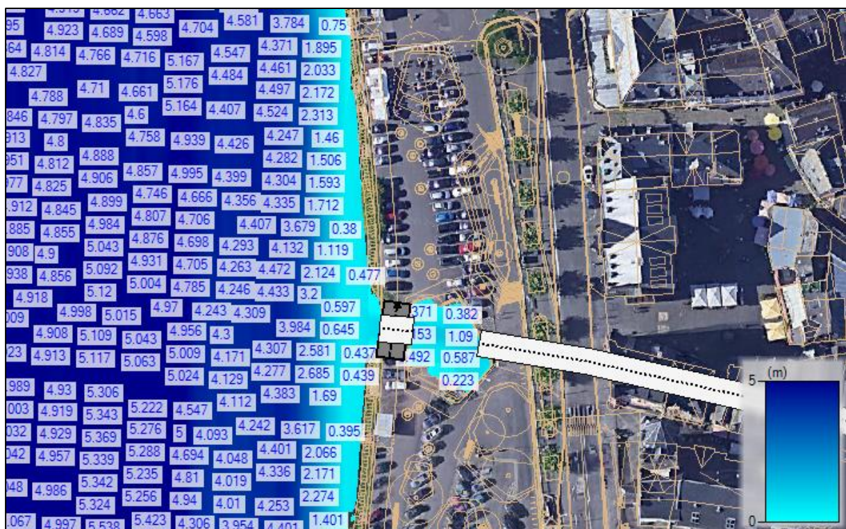
Abbildung 24: Wasserstiefen [m], PLAN-Zustand, Mosel MQ, Tiefenbach HQ 100
