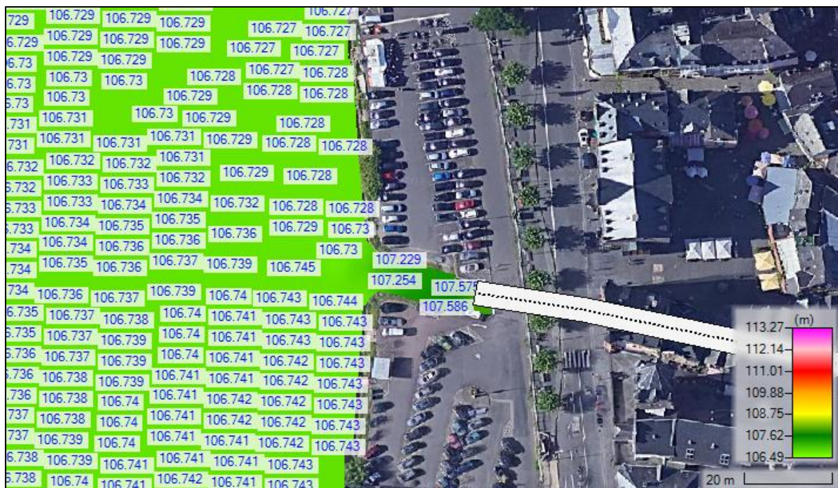
Abbildung 18: Wasserstände [m ü. NN], IST-Zustand: Mosel MQ, Tiefenbach HQ 100
