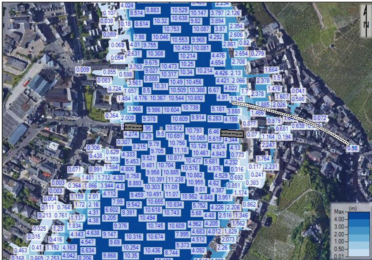
Abbildung 29: Wassertiefen, IST-Zustand: Mosel HQ 100 , Tiefenbach HQ 100
