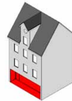
unzulässig: „Aufgerissene“ Erdgeschoss- fassade
