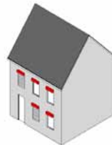
unzulässig: vorstehende Rollladenkästen
