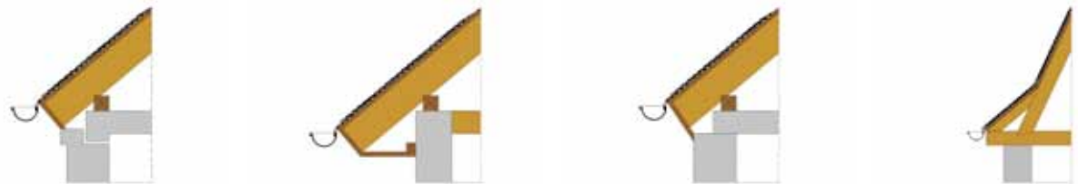
Typische Traufausbildungen im Stadtgebiet. Es ist festzustellen, dass Sparren und Sparrenköpfe regelmäßig verkleidet sind.
