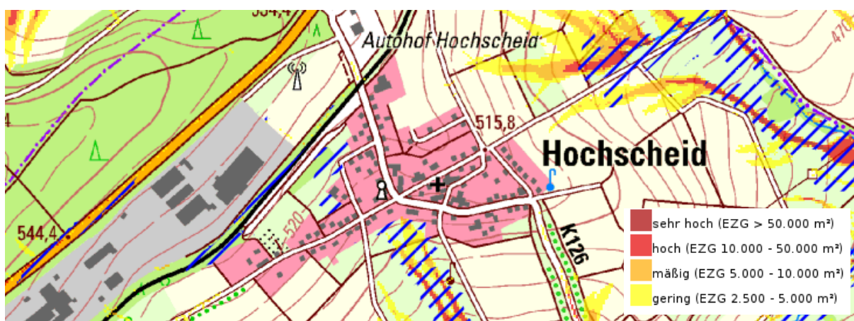
Abbildung 22: Sturzflutgefährdungskarte mit Abflusskonzentrationen im Außenbereich
